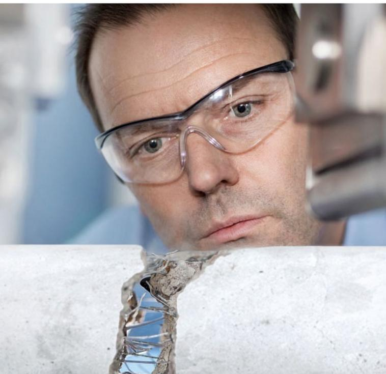
Qualitätskontrolle bei KrampeHarex, Balkenversuch mit Faserbeton
