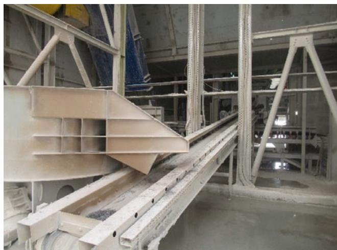
Faserdosiereinheit mit Pufferförderer
