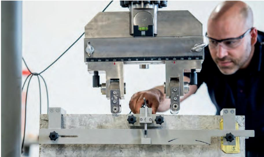
Bild 5: Interne Qualitätskontrolle, Balkentest zur Ermittlung der Faserbetonklasse
