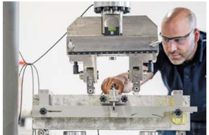
**Bild 5** Interne Qualitätskontrolle, Balkentest zur Ermittlung der Faserbetonklasse
