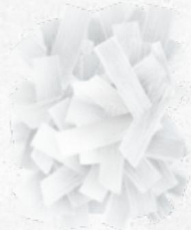
Für passiven Brandschutz, Estriche und Schwindrissreduzierung
