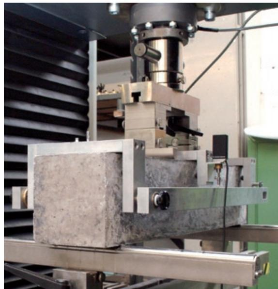
Abbildung 4: Prüfung eines Stahlfaserbetonbalkens
