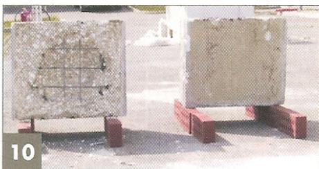
Ergebnisse von Brandversuchen an Kleinproben
