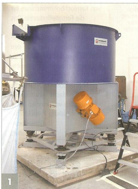
1 Dosieranlage für Fasern mit automatischer Verwiegung
