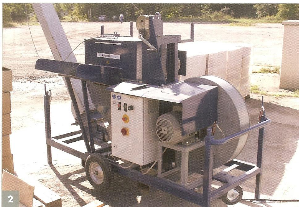
2 Einblasgerät zur Faserdosierung
