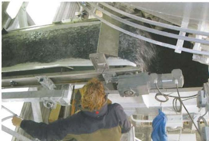
Bild 11: Automatische Zugabe der Stahlfasern
