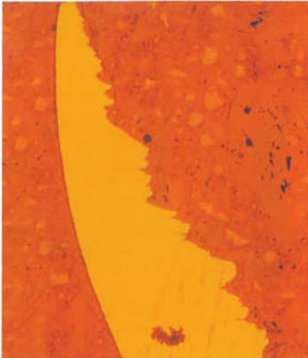
Bild 8: Verzahnung Mörtel/Stahlfaser
