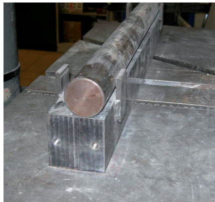
Bild 1. Versuchsaufbau zur Ermittlung der Nachrissbiegezugfestigkeiten
