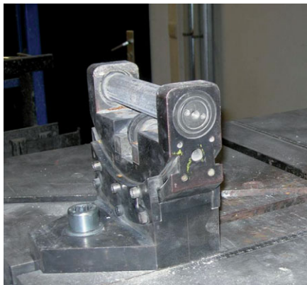
Bild 2. Beispiele für bewegliche Auflager
