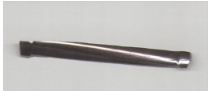
Bild 2: Geprägte Stahlfaser mit glatter Außen- und rauer Innenseite Foto: Vulkan Harex
