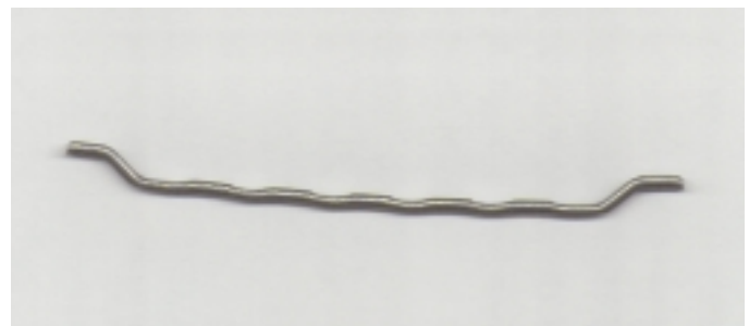
Bild 4: Drahtfaser mit Endhaken Foto: Vulkan Harex
