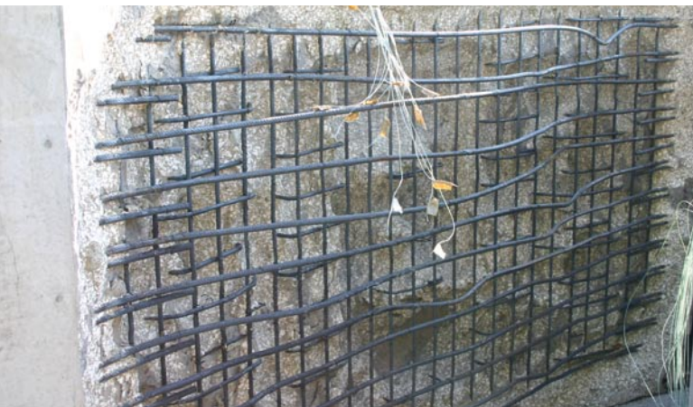
Konventionell bewehrter Tübbing nach Brandversuch
